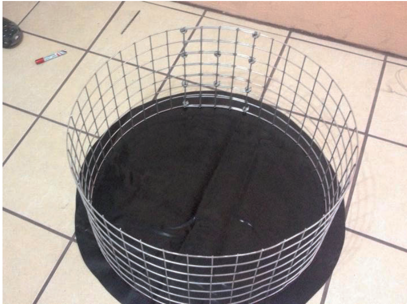
Imagen 4.11 Fabricación del estanque prototipo, que al igual que en los estanques reales se comienza colocando la base circular, para después colocar las paredes.
