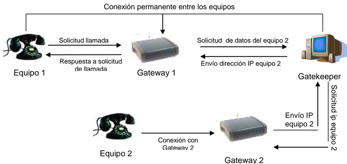
Figura 2.6 Proceso llamada de teléfono a teléfono
