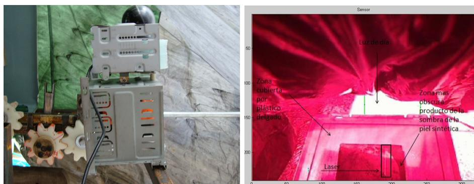
Figura 5.6: SVL cobertura del sensor y resultado de la captura
