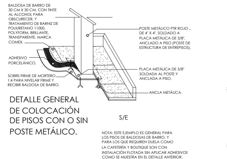
DETALLE GENERAL DE DISEÑO DE PISOS DE BALDOSA DE BARRO.
