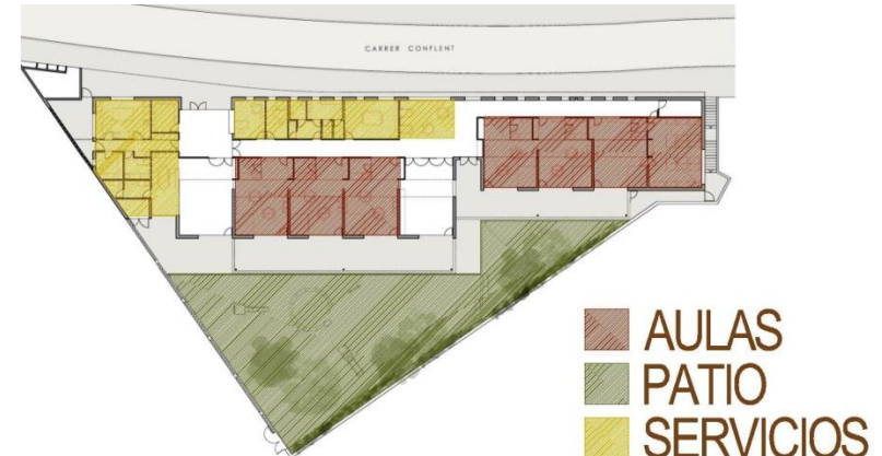
ILUSTRACIÓN 22. LA BALDUFA KINDERGARTEN. PLANTA ARQUITECTONICA
