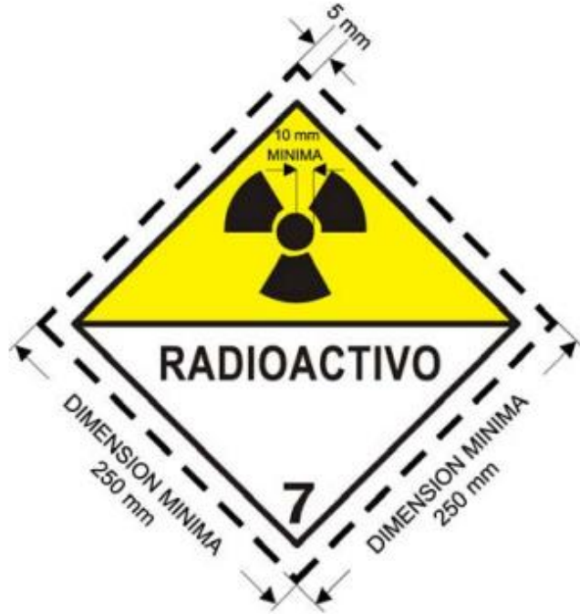
Figura 4.19 “Ejemplo de un rotulado con las dimensiones minimas
