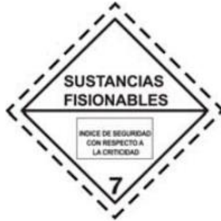
Figura 4.16: “Etiqueta para la clase 7: Material fisionable”
