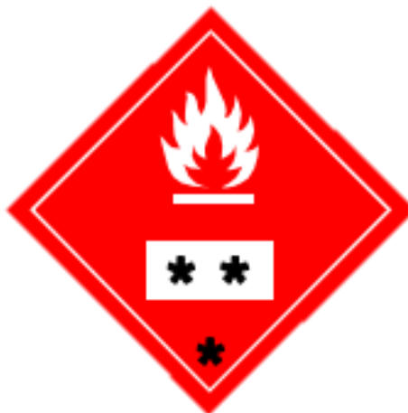
Figura 4.20 “Primer ejemplo de la colocación del número ONU”
