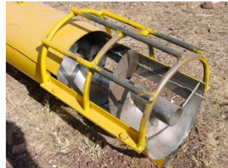
IMAGEN 37. se observa la sección de la tubería por donde acceso el grano a la derecha se aprecia la imagen el motor que mediante un eje mueve el espiral y asciende el grano, una palanca inferior regula la altura. La desventaja de este tipo de equipo es que daña en cierto % el grano al momento de desplazarlo
