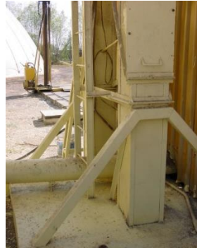
IMAGEN 31. Vista inferior del elevador de grano con los tubos helicoidales de 8" \varnothing que suministran el producto a los silos y están sujetos por tensores de acero al suelo. También se percibe la conexión que tiene el elevador de cangilones con la secadora de grano. 8" \varnothing
