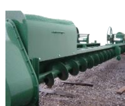
IMAGEN 74. Barredores de Silos
