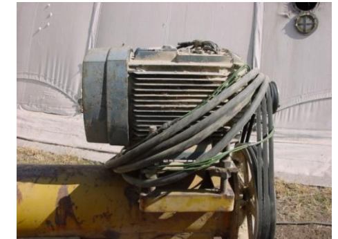
IMAGEN 38. Las bazucas utilizadas en la planta de acopio están impulsadas por motores de 10 y 15 H.P. con capacidad para mover una tonelada cada dos minutos. Este tipo de maquinaria se utiliza para desplazar volúmenes de grano en poco tiempo ya sea dentro de los silos o en el exterior ya que se pueden mover mediante remolques
