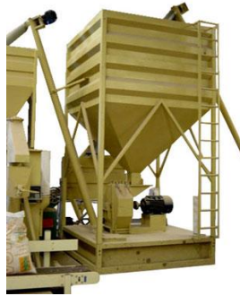
IMAGEN 84 Vista de un Molino de Grano ya instalado bajo la tolva de alimentación.
