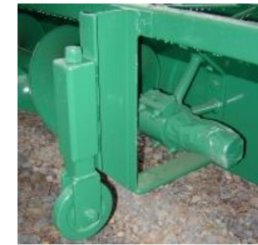
IMAGEN 75 Barredores de Silos
