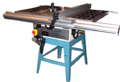
41 Mobiliario móvil, comercial. Sierra de Mesa Modelo: SMMC18 Marca: Silverline Diámetro de disco: 12" Altura de la mesa: 34" Dimensiones: 27" x 40"
