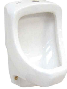
7 Mobiliario fijo, comercial. Mingitorio de cerámica porcelanizado, modelo Rienzi, marca ORION, en color blanco. Descarga de 3.8L Dimensiones: 50.5 x 32.5 x 29.5cm
