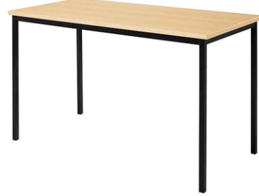
3 Mobiliario móvil, comercial. Mesa escolar rectangular marca ERGOSTYLE Estructura fabricada con tubo de acero cuadrado de 1", esmaltada en negro. La cubierta es fabricada con melamina de 16mm de espesor en color chocolate, con el borde protegido con moldura tipo "T" de pvc. Dimensiones: 60 x 50 x 75cm
