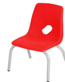
35 Mobiliario móvil, comercial. Silla jardín de niños, modelo Bravo, marca ERGOSTYLE Casco de prolipropileno inyectado de alta densidad Estructura tubular 1" de diámetro calibre 18 varios colores Dimensiones: 30 x 30 x 35cm
