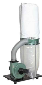
42 Mobiliario móvil, comercial. Colector de aserrín, marca: CentralMachinery Bolsa de fondo claro, ruedas giratorias para fácil transporte, interruptor con llave. entrada de 4" y salida de 4" Dimensiones: 33 x22 x 75"
