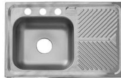
24 Mobiliario fijo, comercial. Fregadero con escurridor derecho, marca EB Técnica, modelo M.102 Fabricado de acero inoxidable para empotrar con acabado satinado. Espesor de 0.061cm, calibre 24 Dimensiones: 80 x 52 x 14cm
