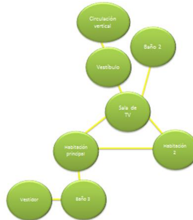
Figura 33. Diagrama de funcionamiento, Planta alta.
