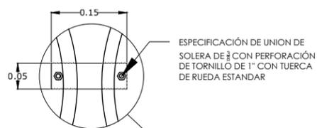
ESPECIFICACIÓN DE UNIÓN DE SOLERA DE 3/8" CON PERFORACIÓN DE TORNILLO DE 1" CON TUERCA DE RUEDA ESTANDAR
