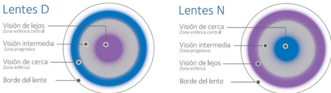
Imagen 3. Diseño de los tipos de lentes de contacto multifocales, Biofinity (CooperVision, 2019)
