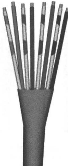
Ya ordenados, los cables deben juntarse y cortar las puntas, para que estén todas al mismo nivel y no haya problemas al insertarlos en el conector RJ45. Los pares juntados y nivelados deben verse así:
