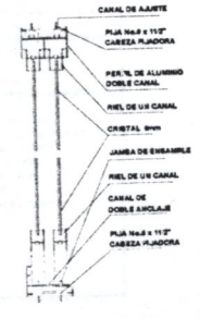
SECCION VERTICAL (Para ventanas corredizas)
