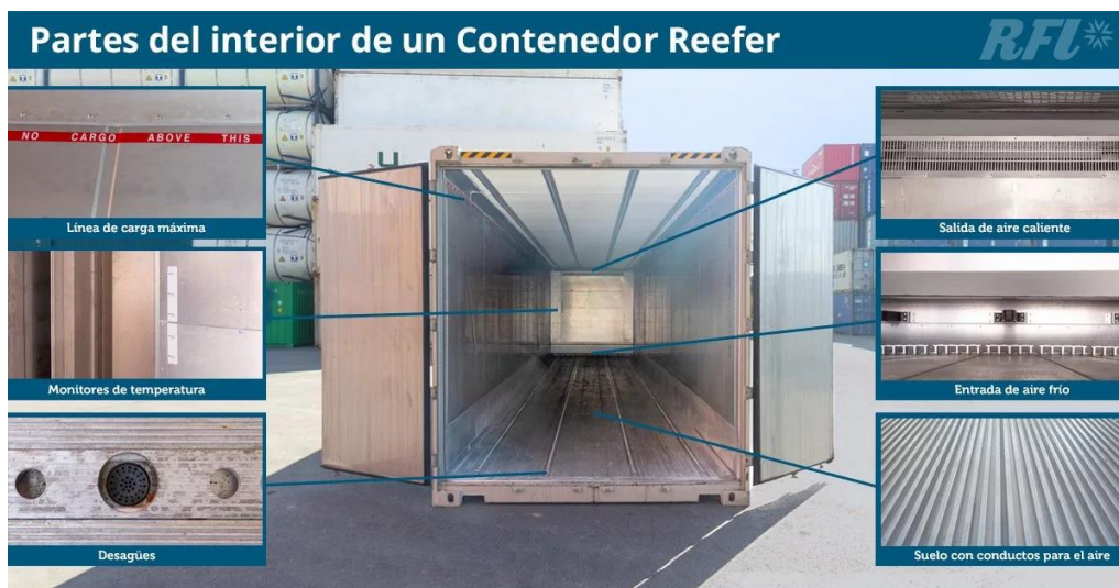
Figura 31 Interior del contenedor
