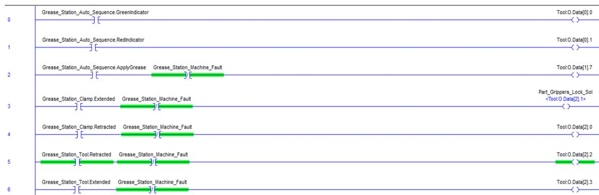
Imagen 3.6 Mapping señales de salida.
