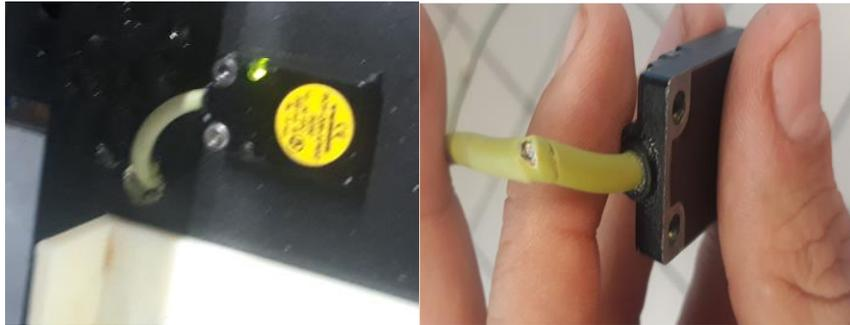
Imagen 4.2 Sensor capacitivo recién puesto/ Sensor trozado.
