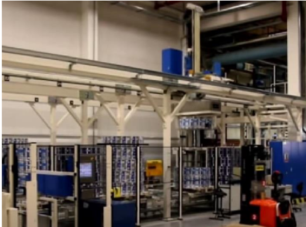
Ilustración 6 (Canal Tetra Pak Magyarország, 2014) Grúa apilando rollos individuales en tarimas.
