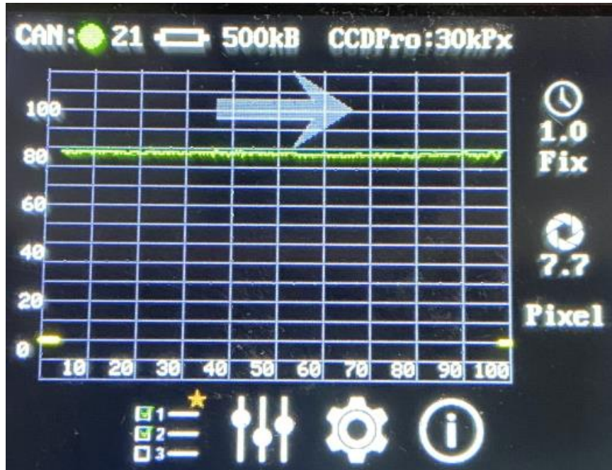
Ilustración 24 Señal en línea recta compensada por el cálculo de balance de blancos.
