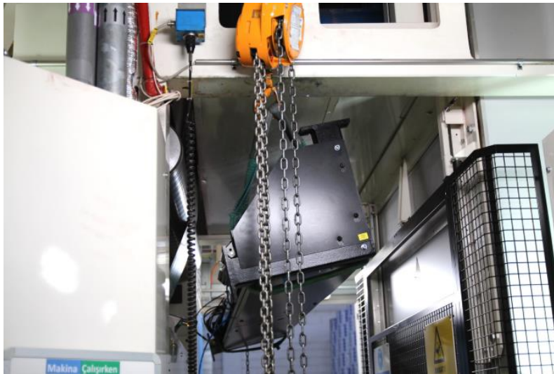
Ilustración 16 Colocación del marco de las cámaras de centrado de impresión usando polipastos manuales.
