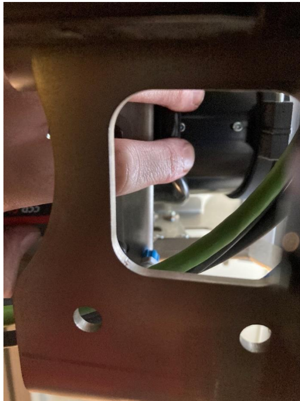
Ilustración 20 Opresores protegidos por una cubierta de plástico flexible para evitar que caigan en el material.
