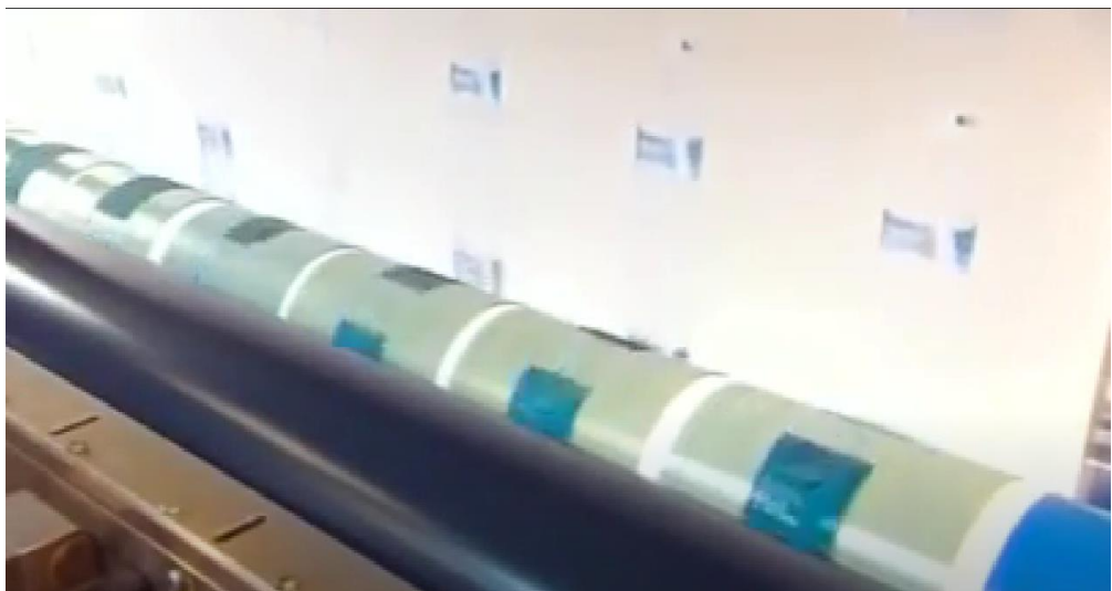
Ilustración 3 (Canal Tetra Pak Magyarország ,2014) Unidad de impresión con los rodillos (de izquierda a derecha) anilox y plate transfiriendo tinta al papel.
