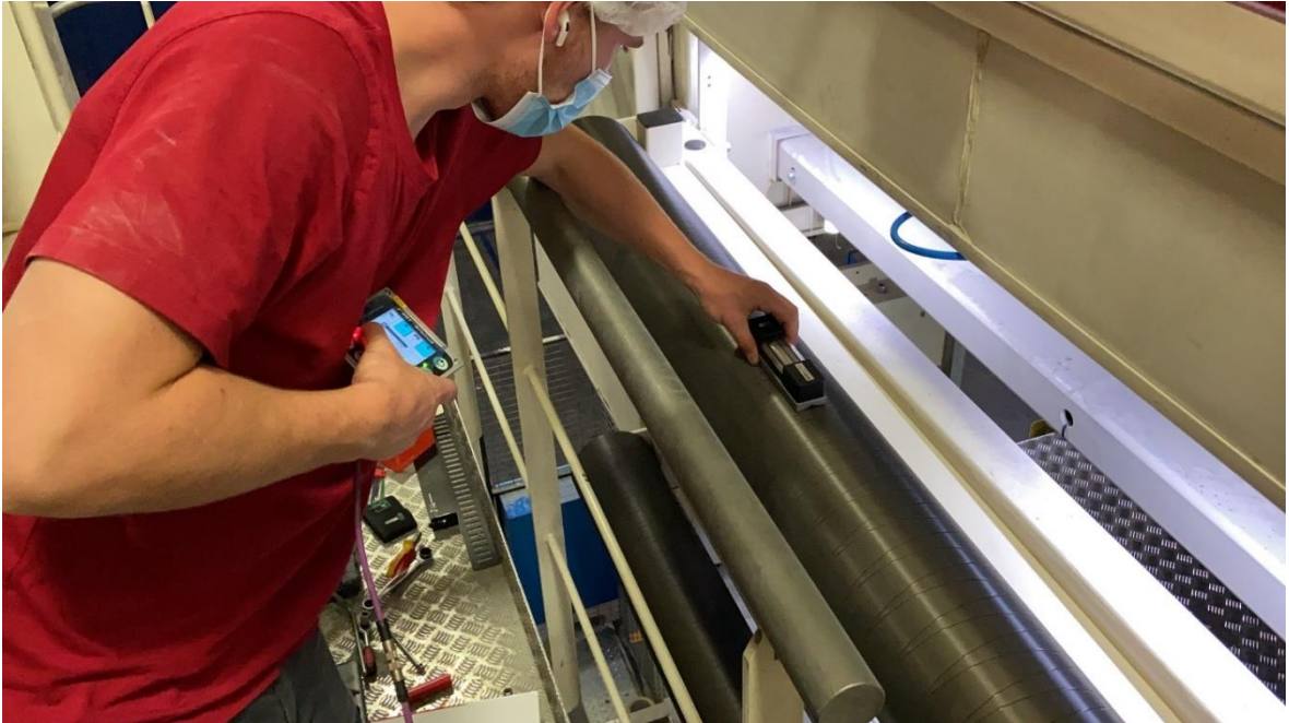
Ilustración 13 Nivelación de marco de alineación de entrada, se usa un control para mover manualmente el alineador.
