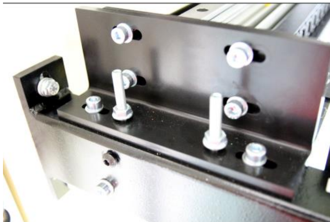
Ilustración 28 Tornillos de fijación de los rieles de las cámaras
