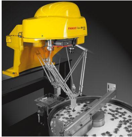
Figura 2.9: Robot delta M-1iA/0.5A. Fuente: Fanuc, 2017
