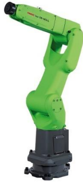
Figura 2.10: Robot colaborativo CR-14iA/L. Fuente: Fanuc 2017
