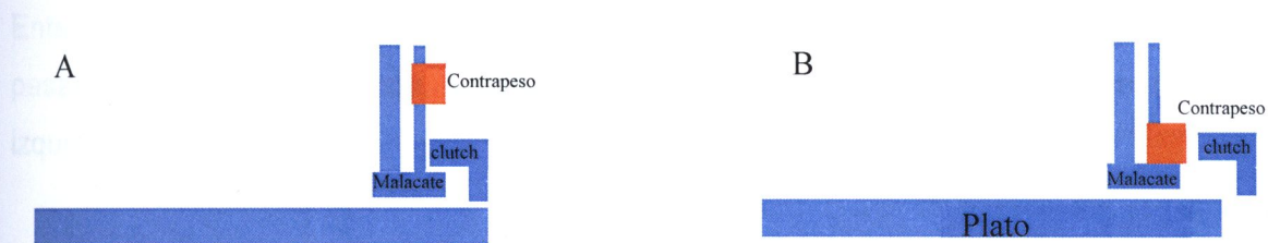
Ilustración 8. Posición A poka yoke inactivo, posición B poka yoke activo. Creación propia.
