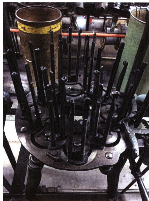
Ilustración 21. Malacates colocados en trenzadora kokobun.
