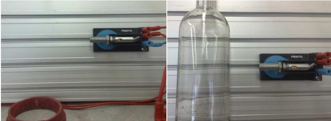
Fig. 9.2.2.5 Sensor de posición
