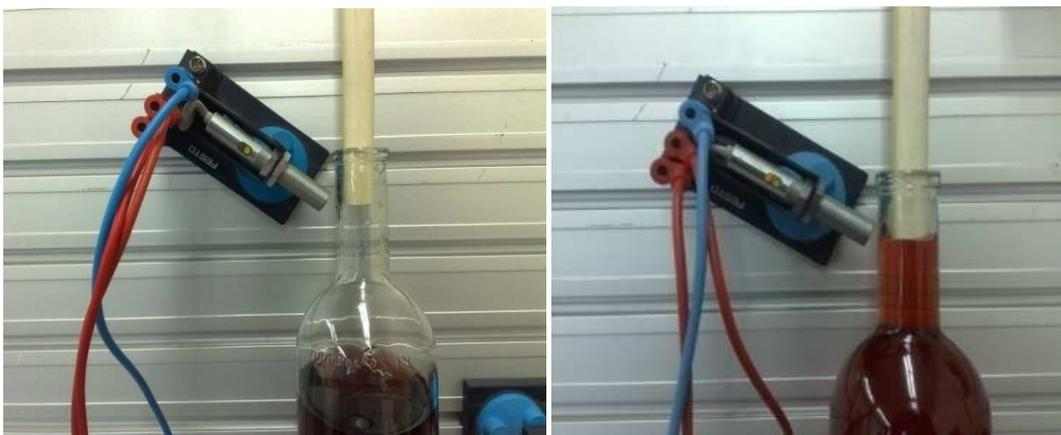
Fig. 9.2.2.9 Comparación de los sensores de límite de llenado
