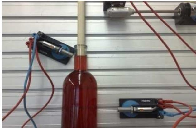
Fig. 9.2.2.10 Sensor de nivel encendido
