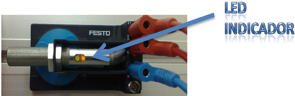
Fig. 9.3.2.4 Sensor de posición proceso taponado
