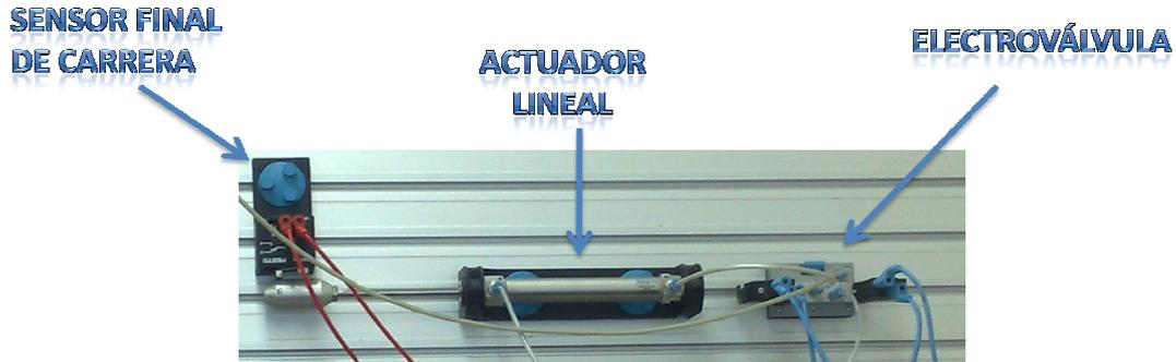
Fig. 9.2.2.6 Electroválvula de avance y Actuador neumático
