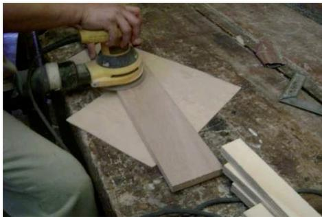
**FIGURA 4-24.** Proceso de lijado de rampas.
