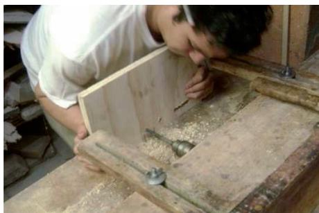
**FIGURA 4-23.** Realización de aberturas para los actuadores.
