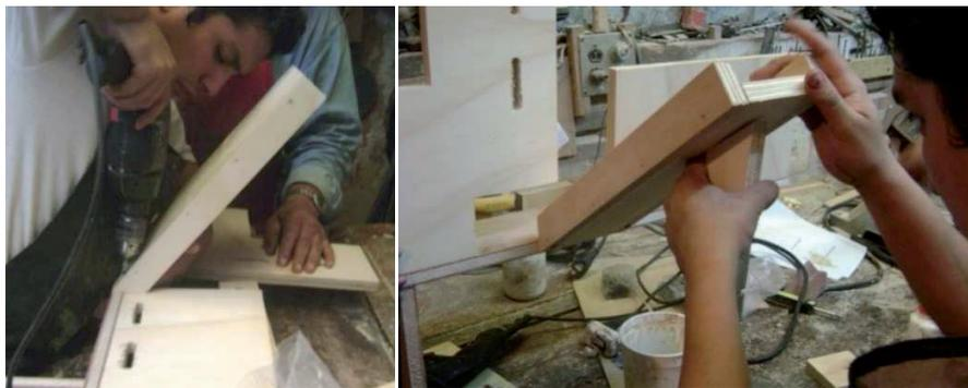
**FIGURA 4-27.** Armado de rampa alimentadora con bases de actuadores.
