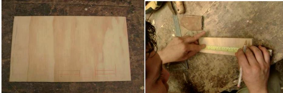
**FIGURA 4-21.** Corte bases de cilindros actuador A y B.
