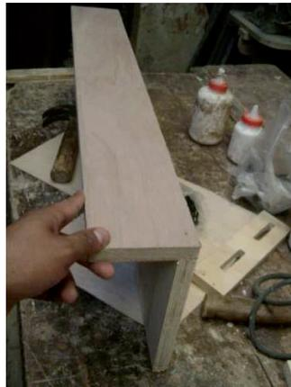
**FIGURA 4-25.** Armado de rampas alimentadora y de salida.
