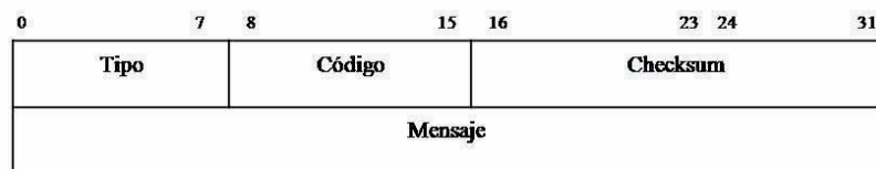
Figura 5- 7 Formato del ICMP versión 2 compatible con la versión 6 de IP
