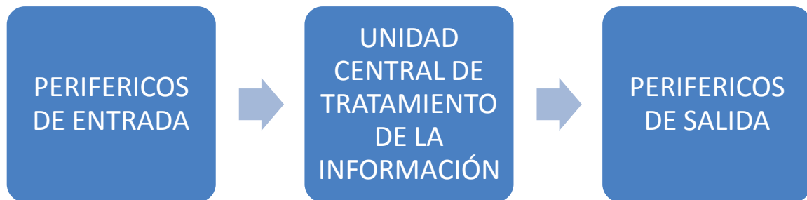
Figura 2.1. Diagrama de bloques de un sistema automatizado. [1]
