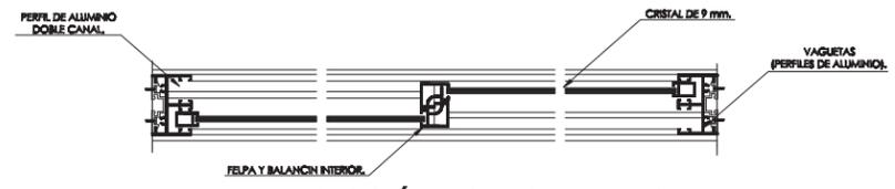
**DETALLE SECCIÓN HORIZONTAL TIPO (Para ventanas y puertas corredizas).**
