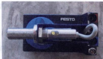
Ilustración 12 Sensor de Proximidad Óptico
