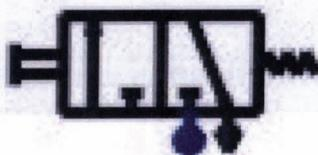
**Ilustración 6 Símbolo de una válvula 3/2 vías con accionamiento manual y retorno por muelle**
