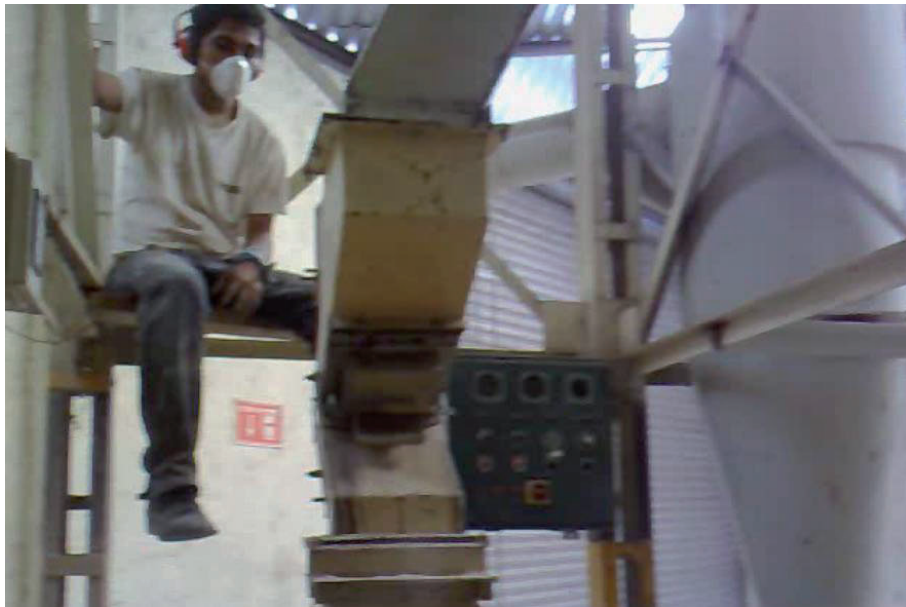
Figura 1.- Operador en posición no segura.
