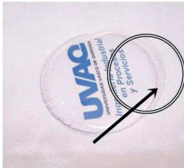
Figura 4.11 En esta imagen se observa un fotoboton con defecto, no fue prensado adecuadamente, se puede observar que el plástico protector quedó por fuera del prensado, al automatizar el prensado estos defectos se van a eliminar ya que la fuerza de la prensa es constante.
