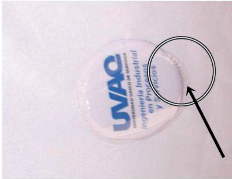
Figura 4.11 En esta imagen se observa un fotoboton con defecto, no fue prensado adecuadamente, se puede observar que el plástico protector quedó por fuera del prensado, al automatizar el prensado estos defectos se van a eliminar ya que la fuerza de la prensa es constante.
