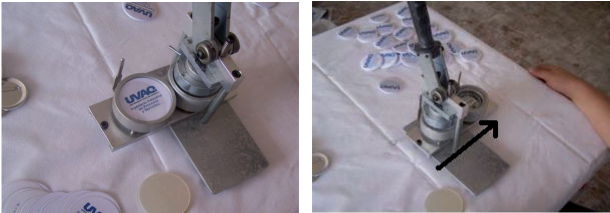
Figura 4.14 Movimiento 1 desplazamiento de la base móvil.
