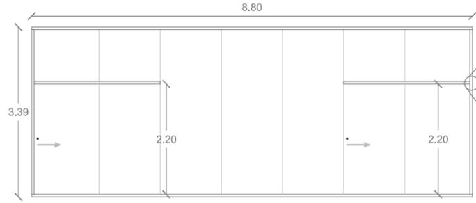
**FI\_03** FIJO DE CRISTAL TEMPLADO CLARO DE 10MM DE ESPESOR, COMPUESTO POR HOJAS DE CRISTAL DE 1.22 ANCHO ASENTADO SOBRE PERFILES DE ALUMINIO 'HERCULITE' ACABADO SATÍN. LAS HOJAS ESTARÁN ASENTADAS A HUESO CON SILICON ACRILASTIC. Y CANDEL CORREDIZO CON CHAPA DE DOBLE MANIJA MARCA BRÜKEN MODELO 550 EN ACERO INOXIDABLE ASENTADO EN ALUMINIO ELECTRO E-200 LÍNEA DE BÁSICO DE FACHADA.
