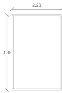
**FI\_08** FIJO DE CRISTAL TEMPLADO CLARO DE 10MM DE ESPESOR, ASENTADO SOBRE PERFILES DE ALUMINIO 'HERCULITE' ACABADO SATÍN.
