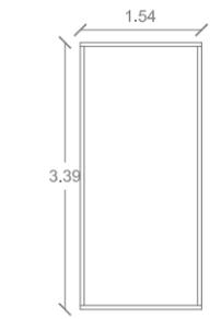
**FI\_02** FIJO DE CRISTAL TEMPLADO CLARO DE 10MM DE ESPESOR, ASENTADO SOBRE PERFILES DE ALUMINIO 'HERCULITE' ACABADO SATÍN.
