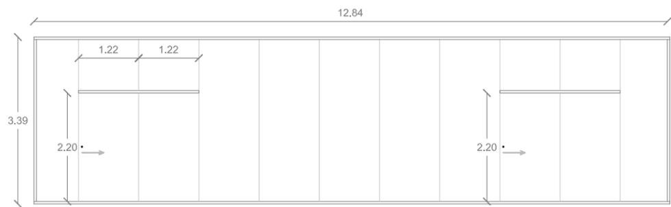
**FI\_04** FIJO DE CRISTAL TEMPLADO CLARO DE 10MM DE ESPESOR, COMPUESTO POR HOJAS DE CRISTAL DE 1.22 ANCHO ASENTADO SOBRE PERFILES DE ALUMINIO 'HERCULITE' ACABADO SATÍN. LAS HOJAS ESTARÁN ASENTADAS A HUESO CON SILICON ACRILASTIC. Y CANDEL CORREDIZO CON CHAPA DE DOBLE MANIJA MARCA BRÜKEN MODELO 550 EN ACERO INOXIDABLE ASENTADO EN ALUMINIO ELECTRO E-200 LÍNEA DE BÁSICO DE FACHADA.
