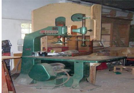
Figura 3.7 Protección en maquinaria (guarda).
