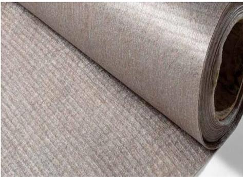
El Geotextil, es una tela permeable y flexible de fibras sintéticas, principalmente polipropileno y poliéster.
