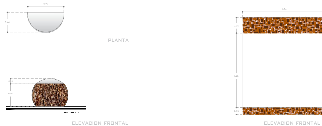
M7 NICHOS DE MADERA NATURAL, CON CUBIERTA DE MICA TRASPARENTE CURVA E ILUMINACIÓN OCULTA. ESC.1:25
