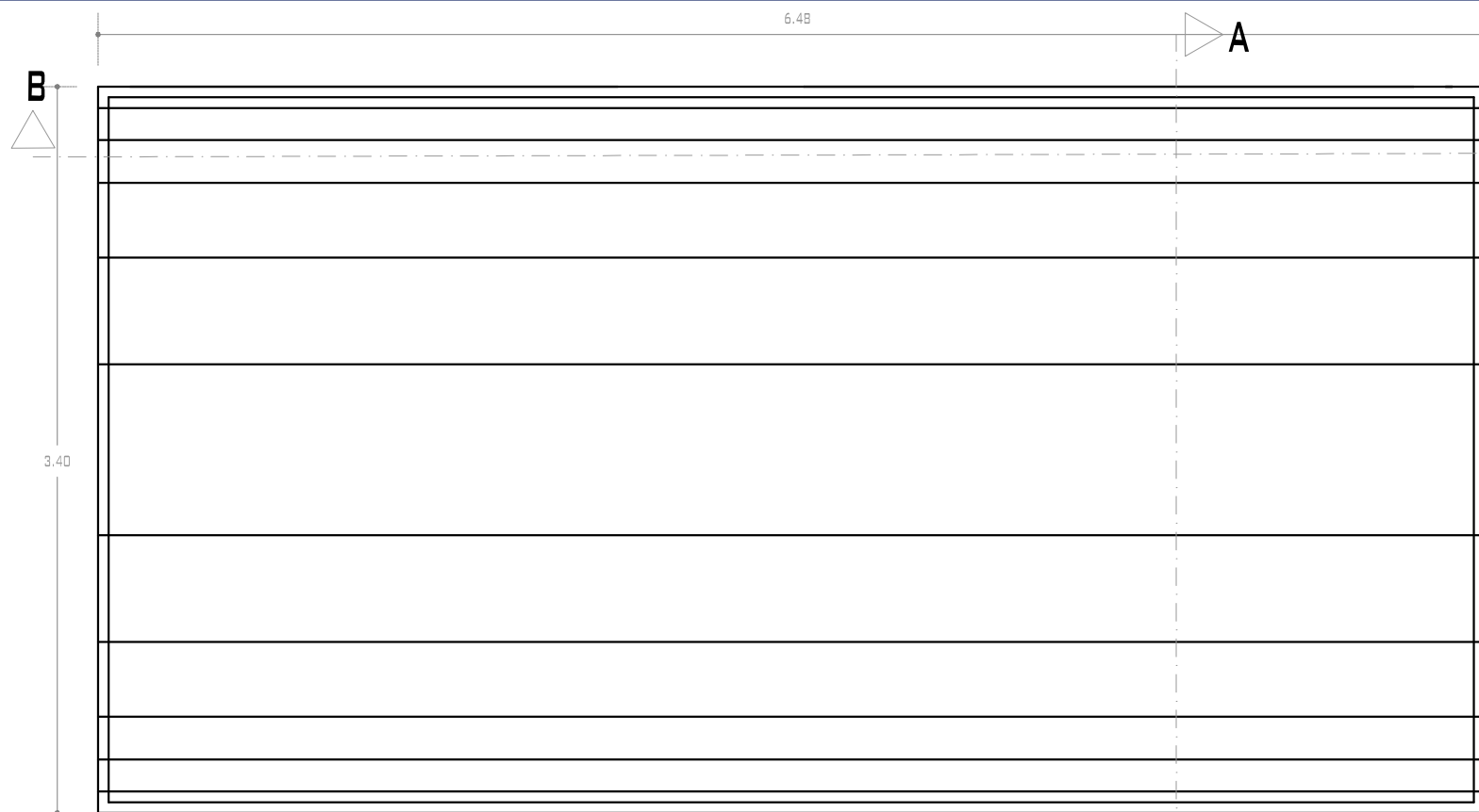
D1 DOMO DE ALUMINIO Y POLICARBONATO COLOR BLANCO MATE DE 6MM. ESC. 1:25
