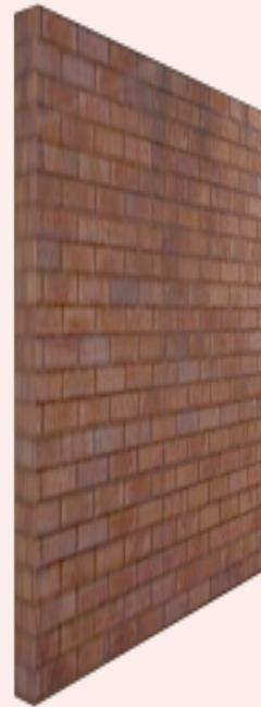
La mampara se basa en un rectángulo elaborado con perfil tubular y mdf de 1/2", forrado con vinilo 3d de ladrillo. Esta va sujeta con solera y tornillos en la parte superior a la mampara de la izquierda.
