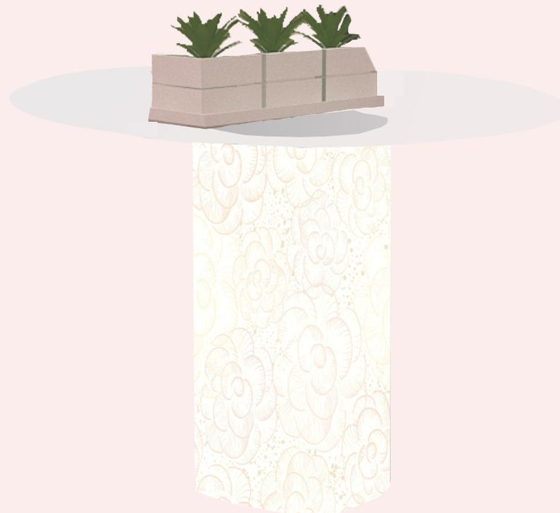
El diseño de la mesa del área de comedor, tiene una cubierta que forma de un plato para taza, fabricada en cristal esmerilado, la base está compuesta por mdf en forma circular, forrado con vinilo de un diseño floral.
