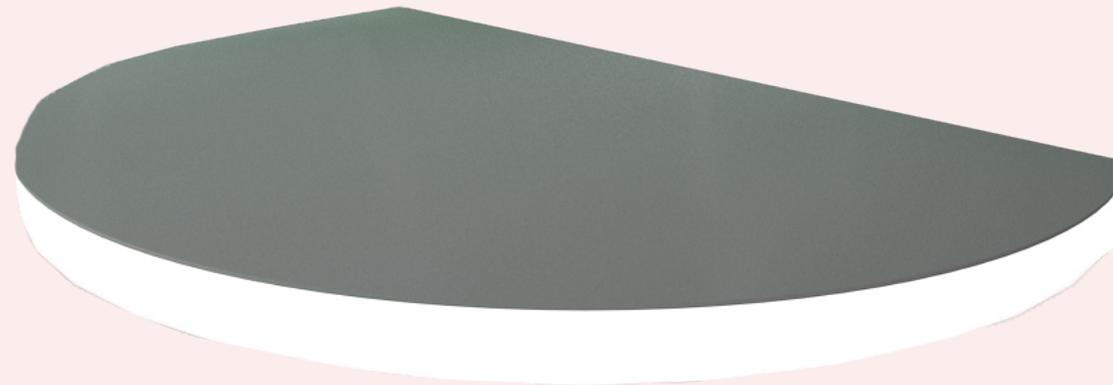
La plataforma semicircular está construída con un bastidor de tubular cuadrado, con una cubierta de mdf de 1/2", con iluminación con barra de led en el interior y acrílico opalina termoformado para permitir traspase la luz . Sobre este se montará la otra plataforma para crear dos escalones y colocar sobre este el área del comentarista.
