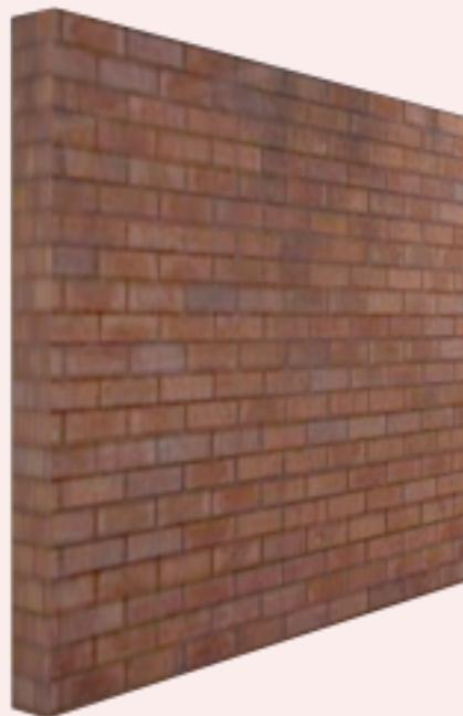
La mampara se basa en un rectángulo elaborado con perfil tubular y mdf de 1/2", forrado con vinilo 3d de ladrillo, en el lado derecho se monta la manguera led con acrílico opalina para permitir traspase la luz, y bañe la mampara que se encuentra a la derecha de esta.
