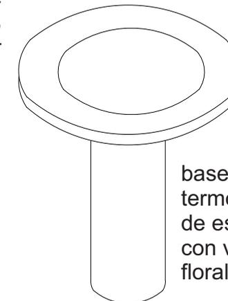
base cilíndrica de mdf termoformado de 1/2" de espesor, forrado con vinilo con diseño floral
