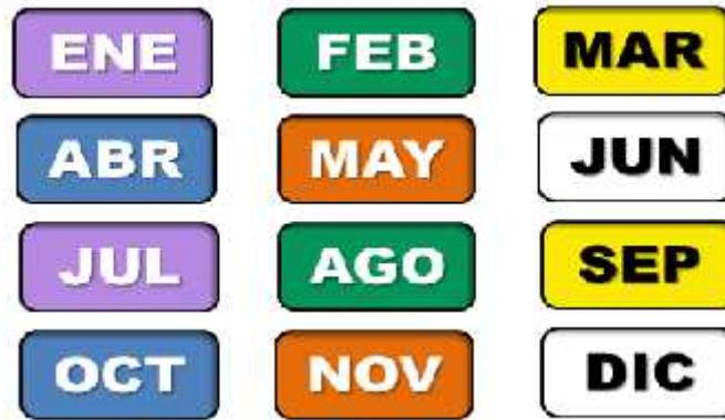
5.2 Para realizar la identificación de los Habilitados metálicos, se utilizarán aerosoles acrílicos del color correspondiente al mes del recibo
