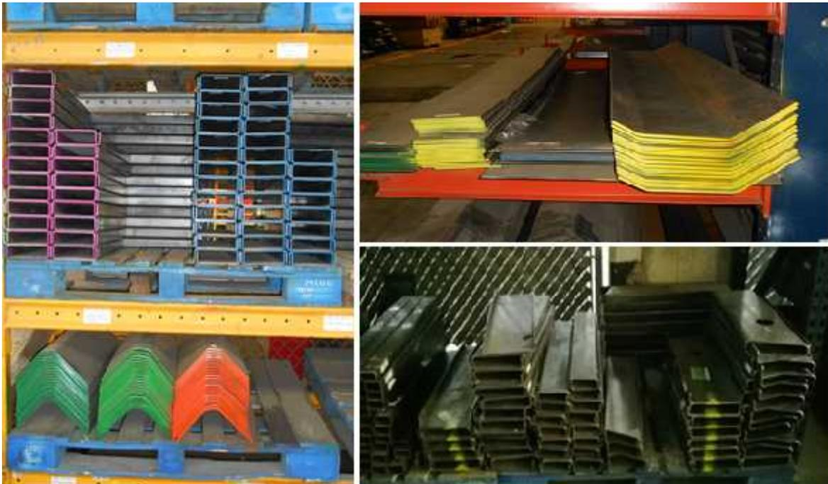
5.3 Para realizar la identificación del material utilizado en ensamble y equipamiento, se utilizarán las cintas de aislar del color correspondiente al mes del recibo; las cintas fueron elegidas para evitar maltratos en el material.
