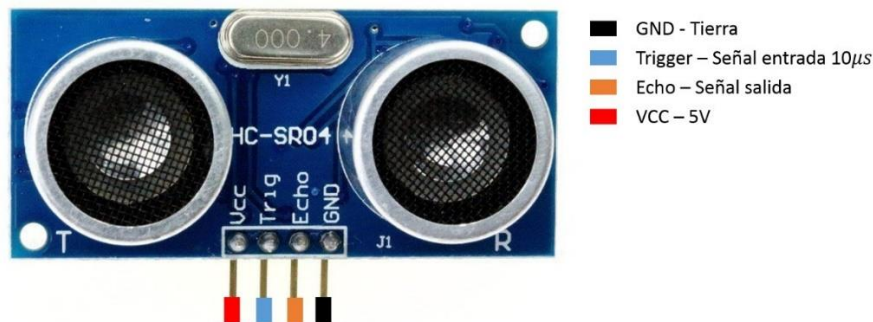
Figura 32: Sensor ultrasónico HC-SR04
