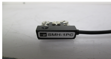
Figura 3.14 Sensor Magnético SMH-1PC.
