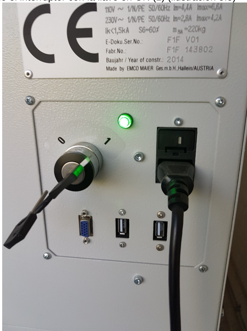
Ilustración 5.5 Interruptor principal (foco verde indica maquina prendida)
