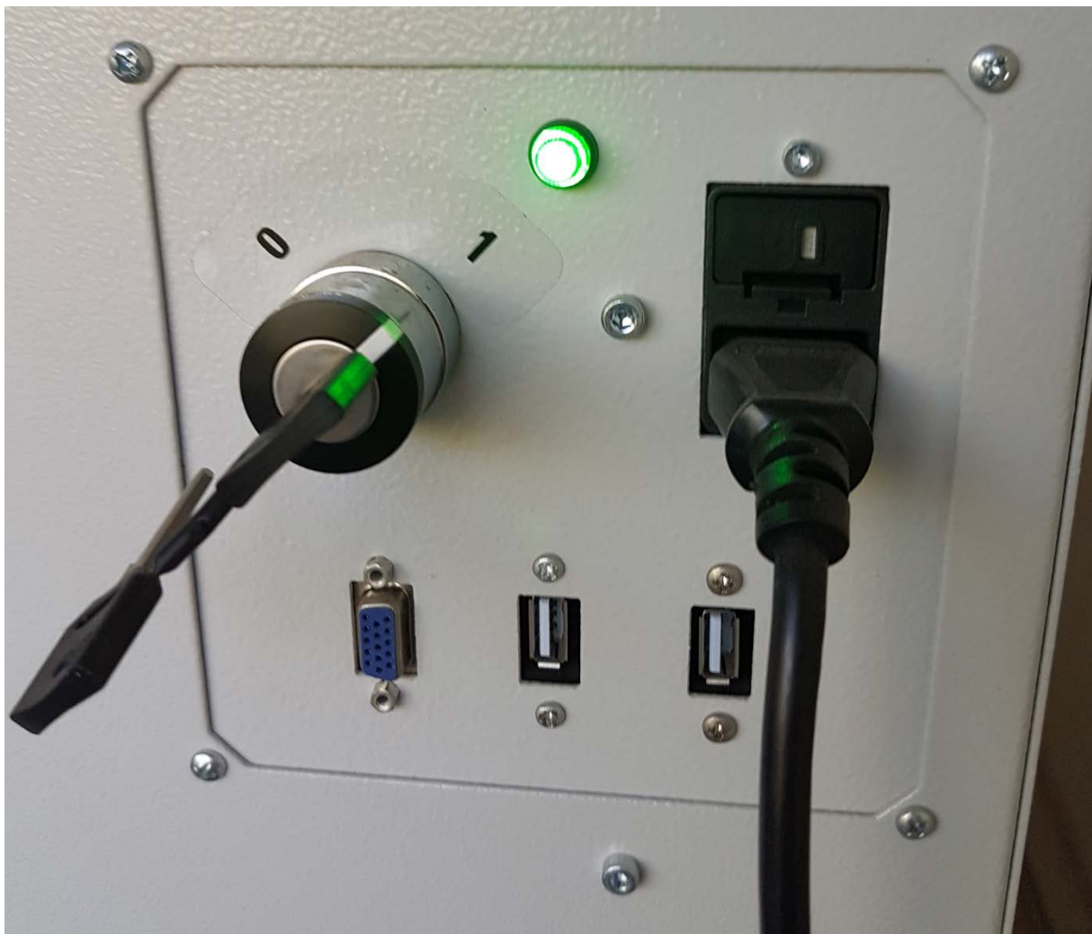
Ilustración 3.17 Conexión Corriente y Llave de prendido
