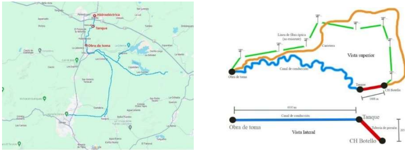
Figura 4 Mapa de relieve de la zona Zacapu a Botello (Izq). Vista de obra civil de la CH Botello (Der). Canal de conducción (color azul), tubería de presión (rojo), carretera Botello-Jiménez (café), línea de fibra óptica por implementar (verde). 2024.
