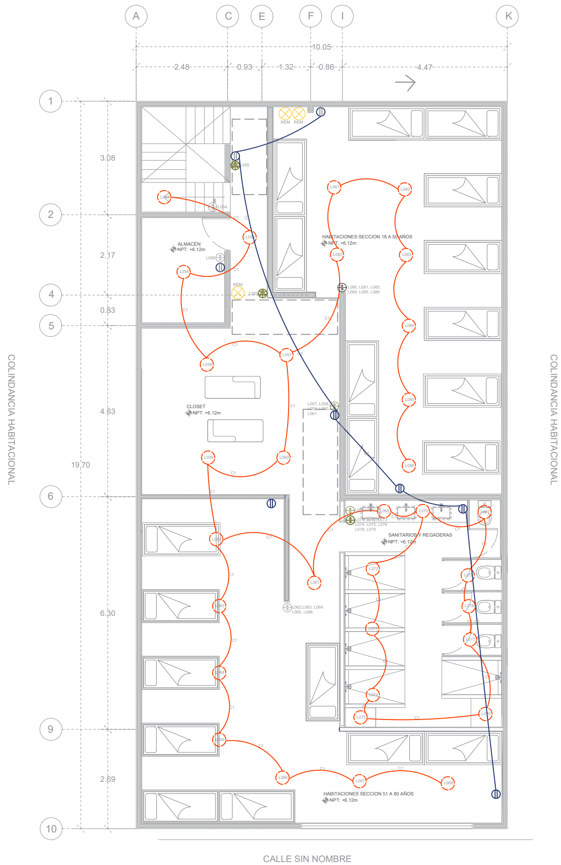
PLANTA C PISO 3 INSTALACIÓN ELECTRICA
