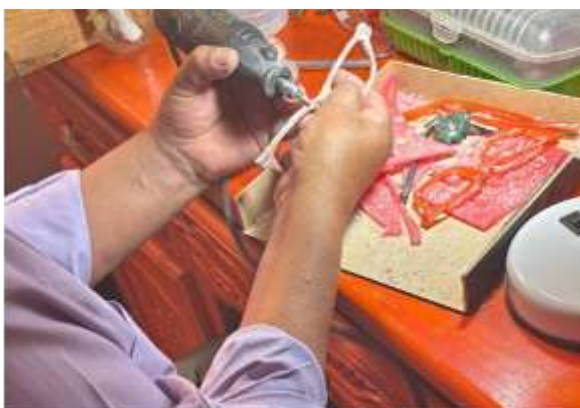
Ilustración 22. Pulido de armazón (Fuente propia, 2024).
