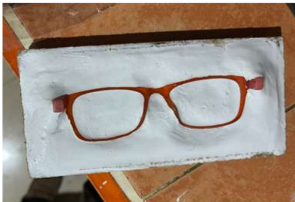
Ilustración 21. Armazón en molde (Fuente propia, 2024).
