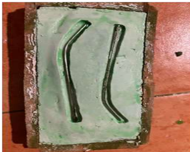
Ilustración 20. Varillas en molde (Fuente propia, 2024).
