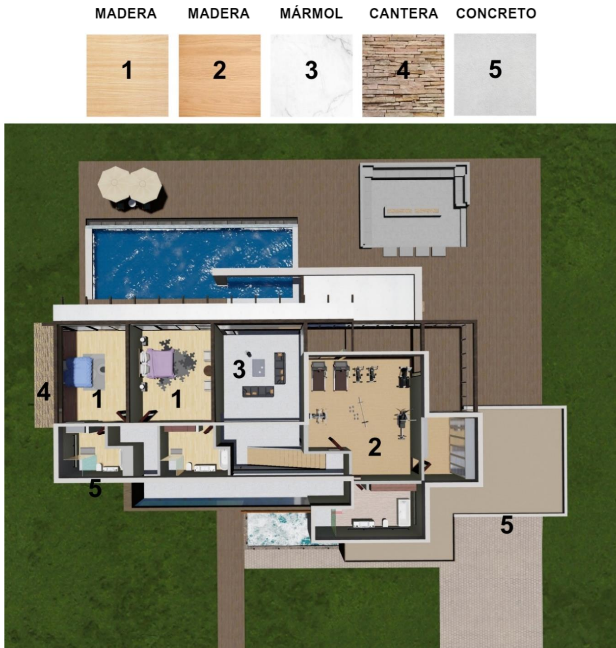
Ilustración 41, Diagrama de Planta arquitectónica, Planta Alta, materialidad, creación propia.
