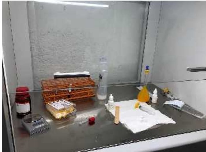
FIGURA 13. Campana de flujo laminar con todo el material de preparación. (Maldonado, B,2021, Campana de flujo laminar con todo el material de preparación, Foto).
