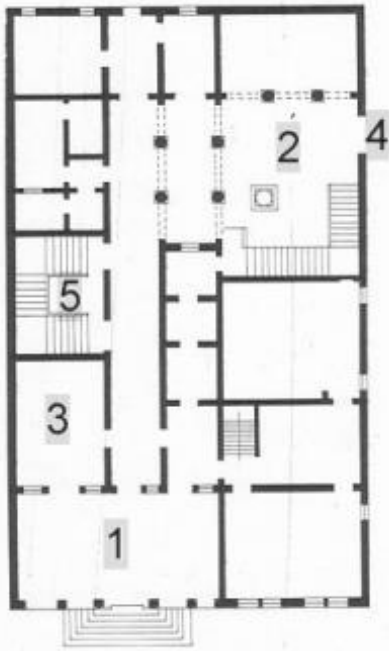
Ilustración 20. PLANTA DE DISTRIBUCIÓN DE LA LLAMADA "CA DÓRO", DISEÑADA POR MARIN CONTARINI AL ESTILO GÓTICO MANTENIENDO LA FACHADA HACIA EL GRAN CANAL DE VENECIA, ITALIA. EN ELLA VEMOS EL USO DE ABERTURAS MAYORES QUE PERMITIAN ILUMINAR NATURALMENTE GRAN PARTE DE LOS ESPACIOS, ESTO GRACIAS A LA IMPLEMENTACIÓN DEL CRISTAL.
