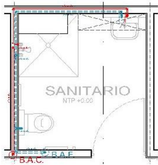
DETALLE 1 INSTALACIÓN HIDRAULICA
