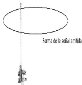
Figura 5.3 Antena Omnidireccional. Se les llama también antenas de fuste vertical. Se utilizan principalmente para emitir la señal en todas las direcciones. En realidad la señal que emite es en forma de óvalo, y sólo emite en plano (no hacia arriba ni hacia abajo).
