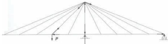
«Carga viva asimétrica P en un caso típico de un puente atirantado con dos cables de medidas de longitud similar.» Cita 15 (Pág: 42)
