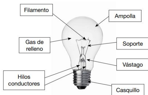
Ilustración 21 Partes de una bombilla incandescente obtenida de http://www.insht.es/InshWeb/Contenidos/Documentacion/Iluminacion%20en%20el%20puesto%20de%20trabajo.pdf
