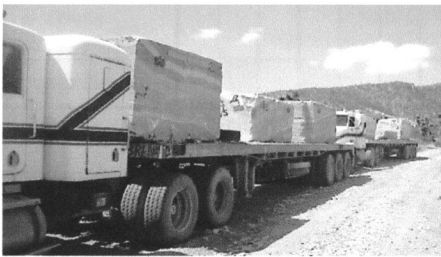
Figura 1. Bloques colocados en trailers listo para el traslado.
