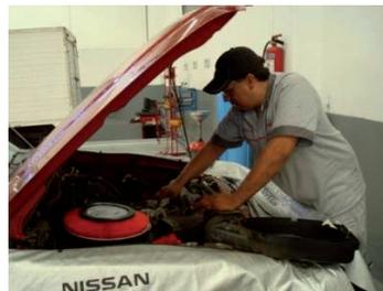
Fig. 3.4.2 Vehículo con protecciones.
