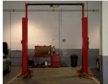
Fig. 2.2.6 Rampa de Portería.
