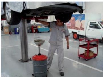
Fig. 3.4.3 Técnico sin equipo de seguridad.
