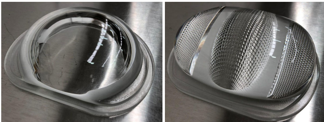
Imagen 19. Difusor liso y Difusor esmerilado. Fuente: Creación propia.
