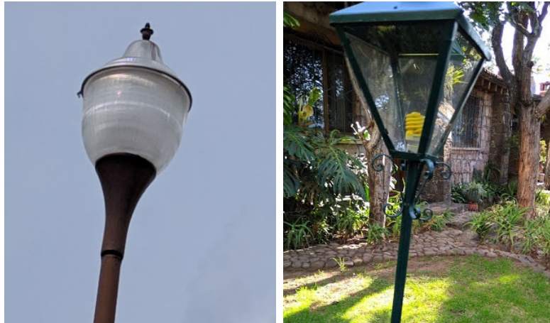
Imagen 9. Luminarias de punta de poste. Fuente: Creación propia.
