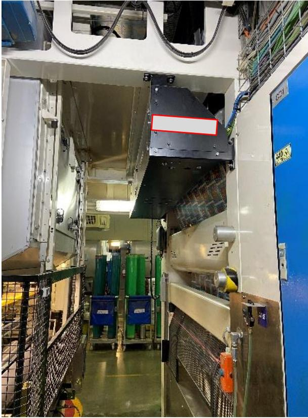
*Ilustración 18 Marco para el sistema de centrado de impresión ya instalado con guardas de color negro.*
