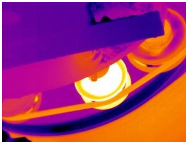
*Ilustración 46 Imagen termográfica de poleas donde se observa que la polea del centro irradia más calor.*
