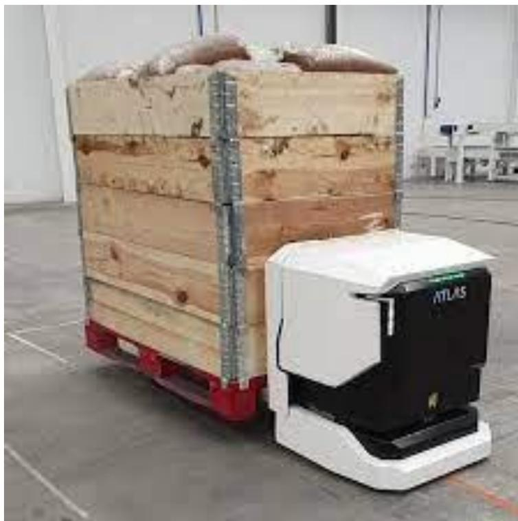
*Ilustración 33 (Atlas Robots, s.f.) Ejemplo de AGV cargando una tarima.*
