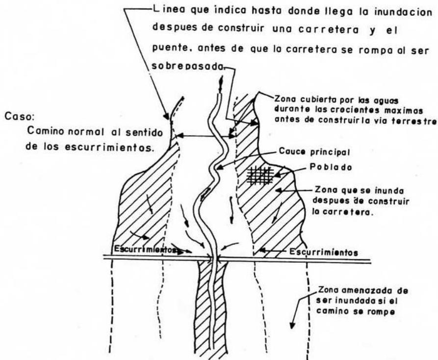
Posibles zonas de inundación debidas a la presencia de un camino con escaso drenaje, construido perpendicular a un río.
