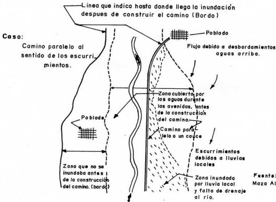
Posibles zonas de inundación debidas a la presencia de un camino sin drenaje, construido paralelo a un río.
