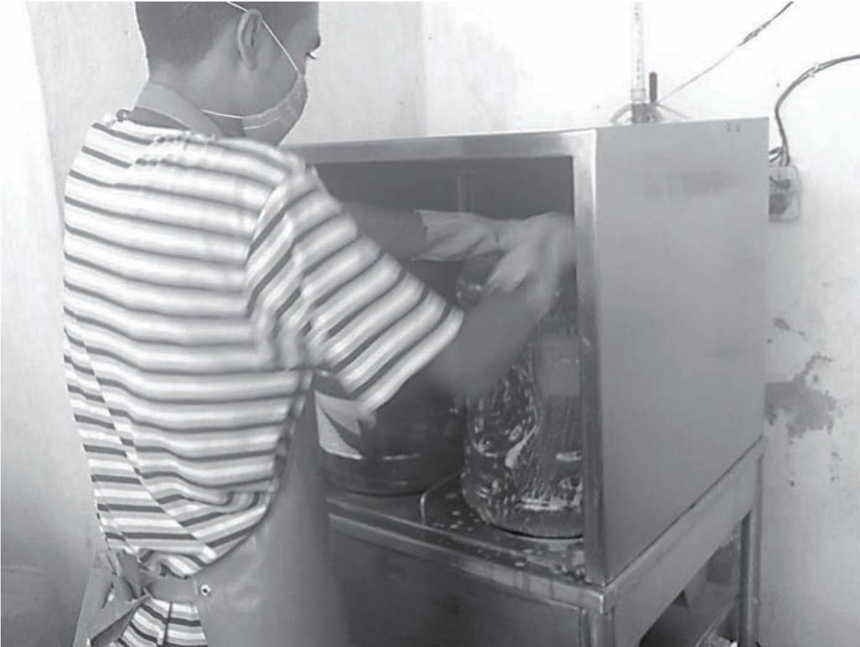
Figura 4.4 Lavado interno y externo del garrafón, método actual
