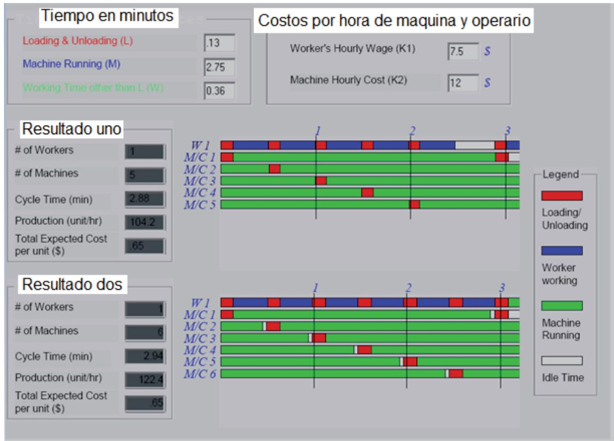
Figura 4.2 Diagrama hombre-máquina del método actual
